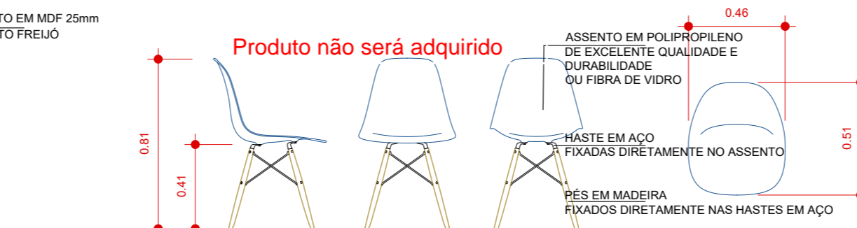
IV. CADEIRA EAMES DSW - 30 UNIDADES ESCALA 1:25 OBS.: Novas especificações no Termo de Referência É IMPORTANTE QUE AS CADEIRAS SEJAM MUITO CONFORTÁVEIS E DURÁVEIS E QUE A FÁBRICA TENHA OS DIREITOS RECONHECIDOS PELA FUNDAÇÃO EAMES. RECOMENDA-SE QUE AS CADEIRAS TENHAM RESISTÊNCIA IGUAL OU SUPERIOR A 120 QUILOS.
