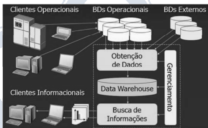
Figura 1: Estrutura interna do DW (HOKAMA et al, 2004)
